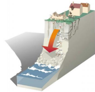
Phénomène d'éboulement, chute de pierres et bloc au niveau d'une falaise
